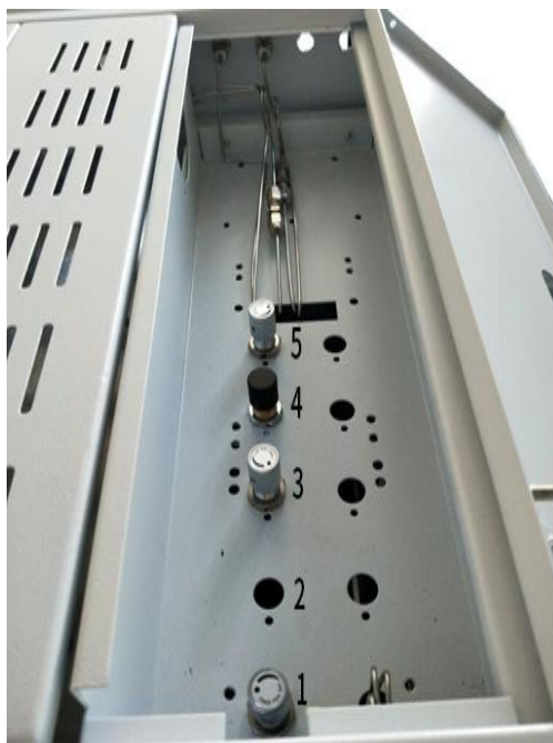
图8（图中1、2、3分别为载气针型阀、氢气针型阀、空气针型阀。4为背压阀，用来调节柱前压力，5为针型阀，用来调节隔膜流量。）
