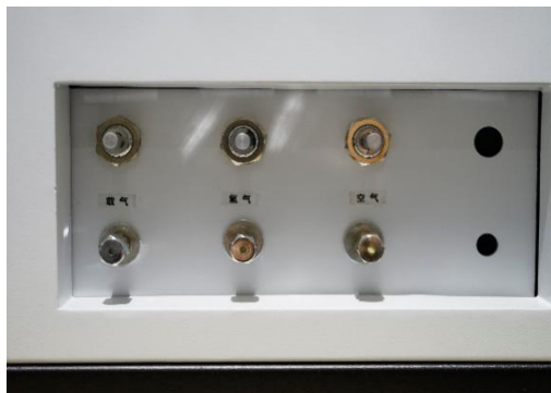
图 5（1 为载气控制开关 2 为氢气控制开关 3 为空气控制开关）其中箭头粗细代表开关方向
